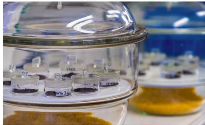
Hier – im Exsikkator – trocknen Proben von Abfallstoffen für die chemische Analyse.
