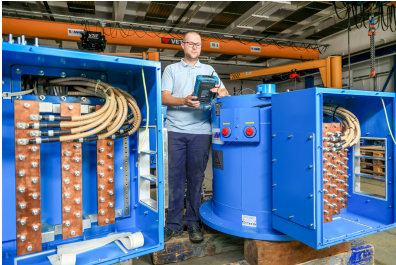
Daniel Kaufmann prüft mit dem Messgerät den Geber des Motors auf seine korrekte Funktionalität.
