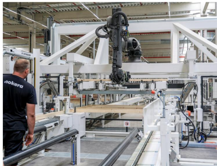
Am Fließband entstehen vollautomatisch die Grundelemente für die Wohnblöcke in Holzbauweise.
